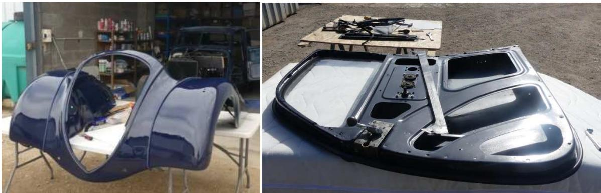
*Pose des vitrages et montage provisoire des tous les éléments de carrosserie, pour vérifier les jeux et les alignements.*
