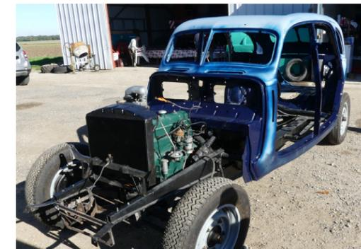
Caisse débosselée apprêtée puis montée sur châssis
